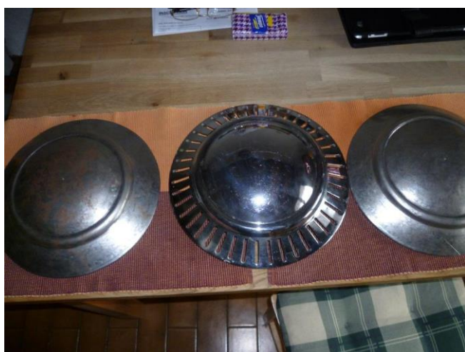
Mes chapeaux pour mes jantes son enfin prêts, la forme au marteau
